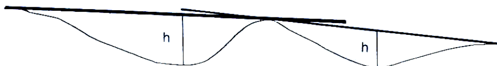
Crtež 1: Postavljanje mjerne letve za određivanje odstupanja pojedinih neravnina h na kolovoznoj površini
