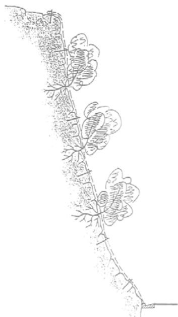
Crtež 3.36: Osiguravanje krunljive sipljive trošne padine sa visećom zaštitnom mrežom. Unešena vegetacija se razvija u matičnoj podlozi
