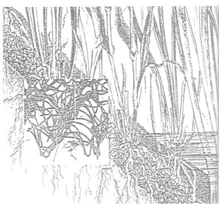
Crtež 6.27: Protiverozijska mreža iz plastičnih vlakana
