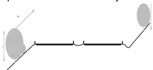
Crtež 6.56: Poprečni profil puta na nasipu sa betonskom odbojnom ogradom i prikazanom širinom za košenje.
