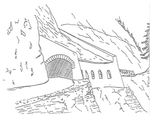
Crtež 6.34: Galerija štiti put pred padajućim kamenjem i snježnim lavinama (masama)
