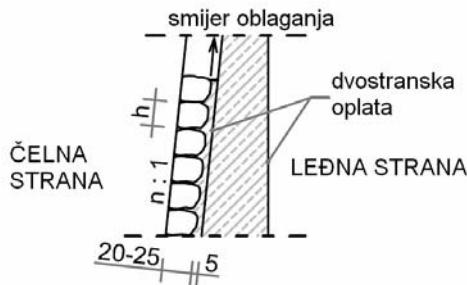
Slika 7.8: Detalj betonskog zida sa naknadnim oblaganjem
